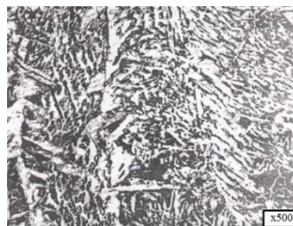
Рис. 4. Микроструктура образца сварного шва из серийной стали 10ХСНД
