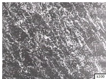
Рис. 4. Микроструктура образца сварного шва из серийной стали 10ХСНД
