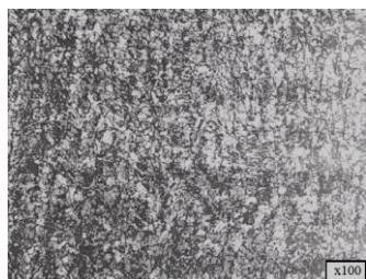
Рис. 5. Микроструктура образца сварного шва из стали 10ХСНД, микролегированной ванадием, после СЭТО
